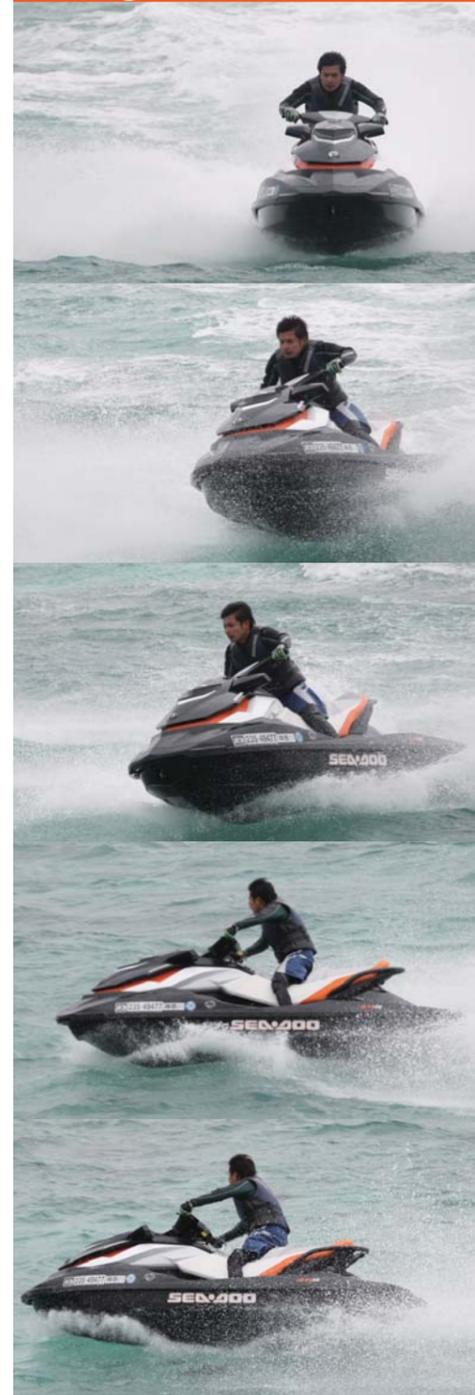
フルモデルチェンジを遂げ、全てが新しく生まれ変わったGTIシリーズ、GTI-SE155。ジェットをもっと楽しく安全にする先進の技術が満載。快適性では電子スロットルiTCを採用、航空機やF1にも搭載される電子スロットルで、スロットルレバーの入力情報を電気信号に変換することで、ライダーの意志を正確に反映しながらも余分な燃料噴射を抑制。混合比や点火タイミングを調節することで燃焼効率を高め、燃費を向上させる。また、ワイヤーケーブルによる摩擦抵抗がなくなることでスロットルレバーのタッチも軽くなり、ライダーの疲労を軽減している。安全面ではiBRを標準装備、世界初の水上ブレーキシステム。水上ブレーキシステム最大の特徴は“安全に減速する”こと、単純に大きな抵抗を作ればそれだけでボートは急停止するが、それではボートにもライダーにも大きな負担がかかる。iBRは、ライダーがiBRレバーを握った入力信号の強弱、ボートスピードをもとに必要な制動力
