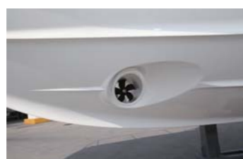
パウスラスタは工場オプション。
