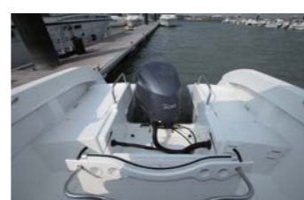
エンジンをチルトアップする際に倒すことが可能。可倒式のモーターウェルボードを採用。アフトベンチクッションはオプションで取り付け可。
