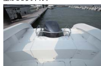
エンジンをチルトアップする際に倒すことが可能。可倒式のモーターウェルボードを採用。アフトベンチクッションはオプションで取り付け可。
