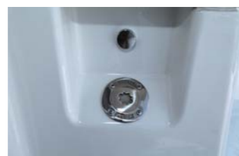
清水タンクの入り口。清水タンクの容量は56リットル。
