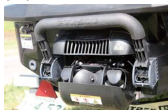
水中からの乗艇をサポートするリポーディングステップ。格納式のため、走行時は邪魔になりません。このポンプ周りにシードゥーの技術が集結している。
