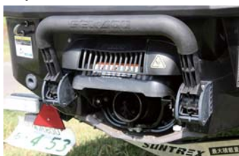
水中からの乗艇をサポートするリポーディングステップ。格納式のため、走行時は邪魔になりません。このポンプ周りにシードゥーの技術が集結している。
