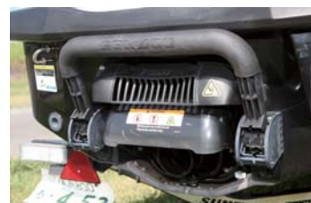
水中からの乗艇をサポートするリポーディングステップ。格納式のため、走行時は邪魔になりません。このポンプ周りにシードゥーの技術が集結している。
