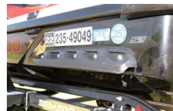
水中からの乗艇をサポートするリポーディングステップ。格納式のため、走行時は邪魔になりません。このポンプ周りにシードゥーの技術が集結している。
