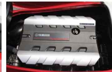
1.8リットルの大排気量にスーパーチャージャーを搭載したエンジン。
