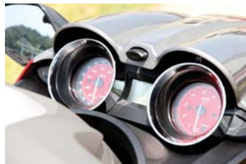
インフォメーションディスプレイではフューエルレベル、電圧、アワメーターなどを表示。2連アナログメーターを装備
