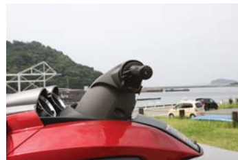
簡単な操作で3段階に伸縮させることができるテレスコピック・ステアリング。最も低いステアリングポジションでは、高速走行時など身を低く伏せ、空気抵抗を避ける前傾姿勢をとることができる。チョッピーな水面では、ステアリングポジションを上げて身体を安定させる。中間ポジションはロングクルージング向き。
