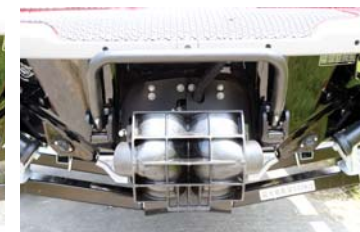
前進時、バック時のステアリングノズルポジション。操作は手動で扱いやすい。
