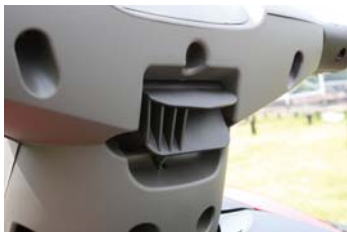
簡単な操作で3段階に伸縮させることができるテレスコピック・ステアリング。最も低いステアリングポジションでは、高速走行時など身を低く伏せ、空気抵抗を避ける前傾姿勢をとることができる。チョッピーな水面では、ステアリングポジションを上げて身体を安定させる。中間ポジションはロングクルージング向き。
