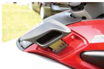
バースシステム。レバー操作ひとつで前進・後進のシフト切替が可能。離着岸時の方向転換が容易になります。
