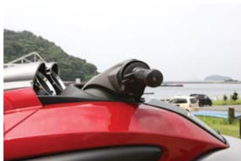
簡単な操作で3段階に伸縮させることができるテレスコピック・ステアリング。最も低いステアリングポジションでは、高速走行時など身を低く伏せ、空気抵抗を避ける前傾姿勢をとることができる。チョッピーな水面では、ステアリングポジションを上げて身体を安定させる。中間ポジションはロングクルージング向き。
