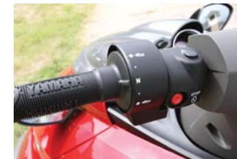
クイック・シフト・トリム・システムQ.S.T.S.左ハンドルのグリップ操作により航走状態に応じたトリムが得られるシステム。
