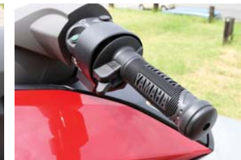
クイック・シフト・トリム・システムQ.S.T.S.左ハンドルのグリップ操作により航走状態に応じたトリムが得られるシステム。
