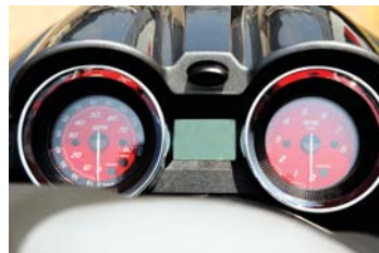
インフォメーションディスプレイではフューエルレベル、電圧、アワメーターなどを表示。2連アナログメーターを装備
