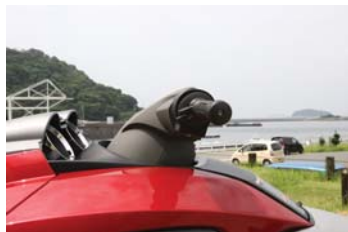
簡単な操作で3段階に伸縮させることができるテレスコピック・ステアリング。最も低いステアリングポジションでは、高速走行時など身を低く伏せ、空気抵抗を避ける前傾姿勢をとることができる。チョッピーな水面では、ステアリングポジションを上げて身体を安定させる。中間ポジションはロングクルージング向き。
