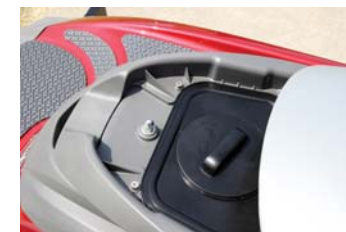
リアシート下に防水のストレージボックスを完備。この下にバッテリーがある。
