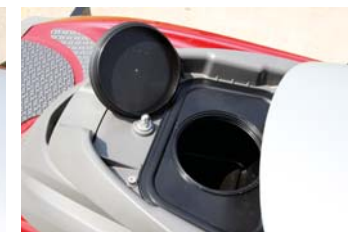
リアシート下に防水のストレージボックスを完備。この下にバッテリーがある。
