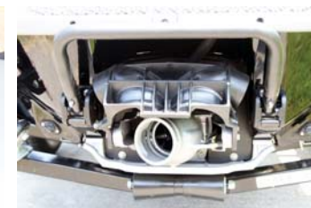
前進時、バック時のステアリングノズルポジション。操作は手動で扱いやすい。
